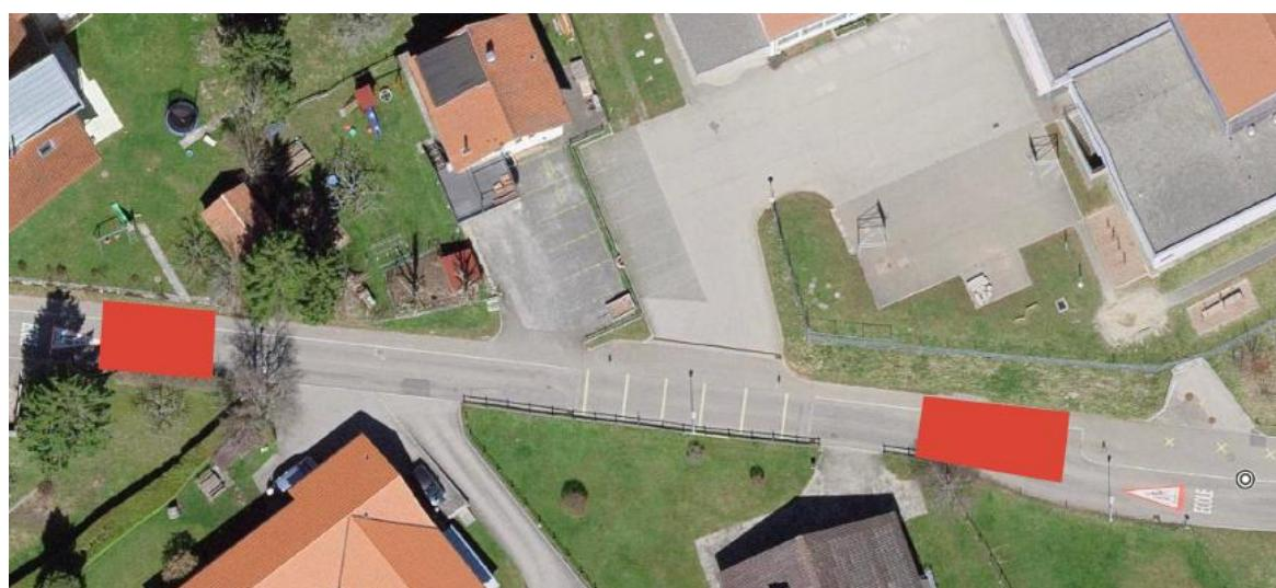
Le type de ralentisseur serait semblable à ceux réalisés à St-Brais et serait d'une longueur de 12 et 15 m et d'une hauteur de 18 cm. La Commune profiterait de la réfection de la route du Prépetitjean pour construire ces deux ouvrages et réaliser une économie au passage.
